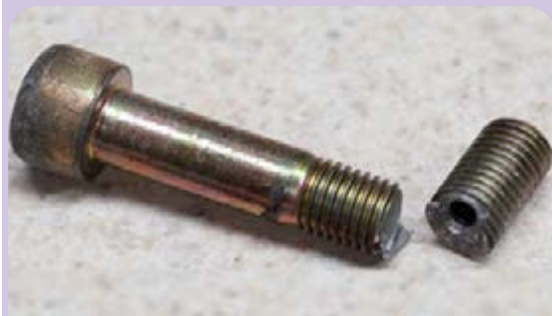
شکل ۳۱- یک پیچ بریده شده بر اثر بارگذاری پیچشی
