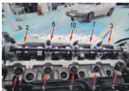
باز کردن پیچ‌های سرسیلندر به ترتیب شماره (روش حلزونی یا ضربدری)
