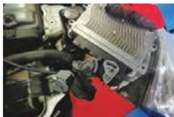
کانکتورهای ECU باز شده و ECU جدا شود.
