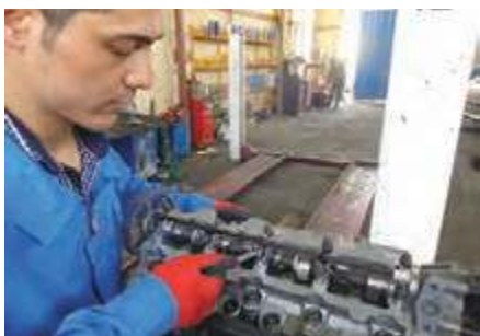
۶ میل سوپاپ بسته و فیلر بررسی شود و در سوپاپ‌ها بسته شود.
