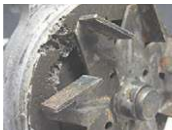
ج) خرابی بلبرینگ و خوردگی داخلی
