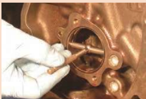
شکل ۳۸- بررسی لقی در یاتاقان یکپارچه
