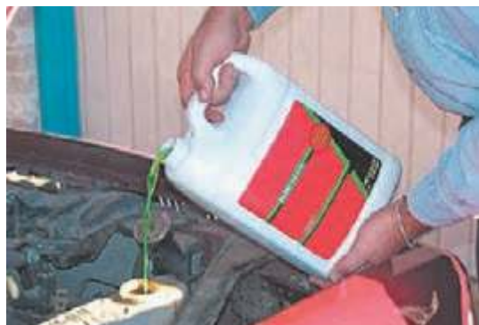
شارژ مایع خنک‌کننده موتور
