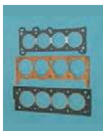
انتخاب واشر سرسیلندر مناسب
