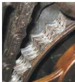
پ) بررسی ظاهری ساییدگی چرخ زنجیر
