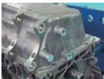
شکل ۱۰۳- بستن کارتیر (در صورت نیاز چسب زدن)
