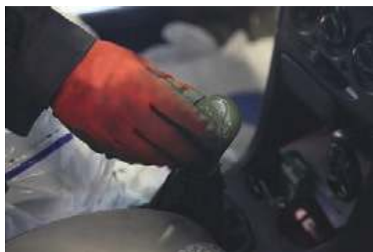
۳ برای جلوگیری از چرخش میل لنگ موتور، با درگیر کردن جعبه دنده، ترمز دستی کشیده شود.
