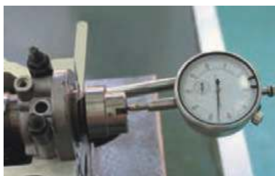
شکل ۸۹- بررسی لقی طولی میل سوپاپ
