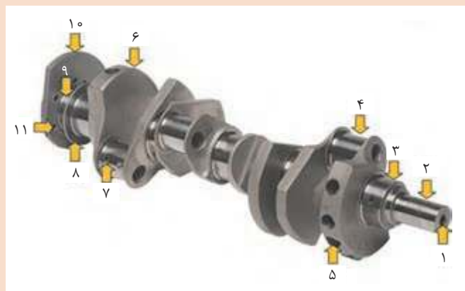
شکل ۲۸- بخش های گوناگون میل لنگ
