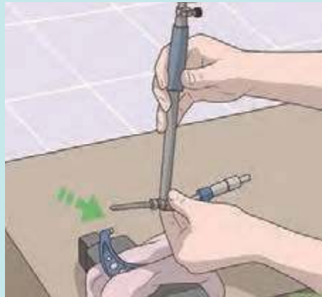
شکل ۸۹- روش تنظیم دهانه ساعت اندازه‌گیری
