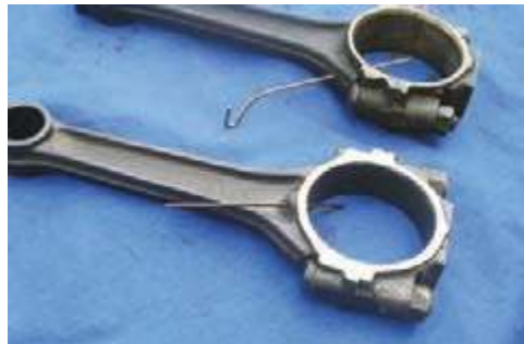
شکل ۲۶- شاتون با مجرای روغن کاری
