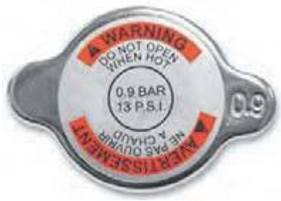
شکل ۱- یک نمونه در رادیاتور و نوشته های روی آن
