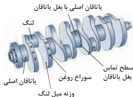
الف) میل لنگ با دو وزنه در طرف مقابل لنگ
