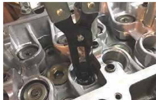
ب) بیرون آوردن کاسه‌نمد سوپاپ‌ها از روی راهنمای سوپاپ
