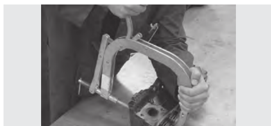
ب) کاربرد فنر سوپاپ جمع کن دستی
