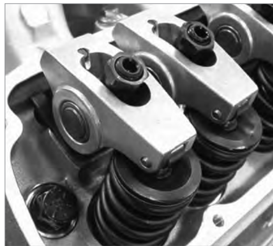
(پ) مجموعه اسبک های غلتکی در موتور OHV دارای تنظیم کننده هیدرولیکی و باتاقان رولبرینگی
