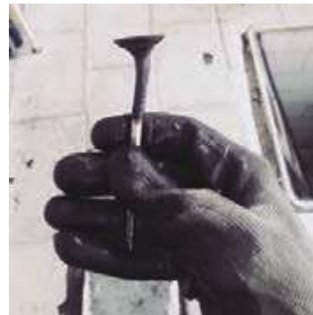
بررسی چشمی تاب سوپاپ
