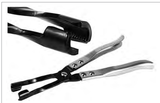
ب) بیرون آوردن کاسه‌نمد سوپاپ‌ها از روی راهنمای سوپاپ
