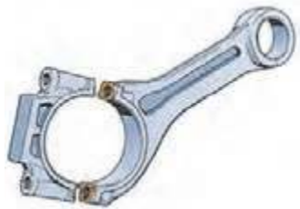
شکل ۲۴- شاتون خارج از محور
