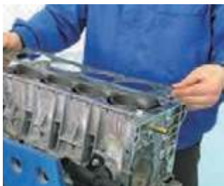
انتخاب واشر سرسیلندر مناسب
