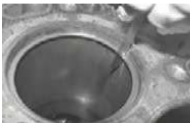
پ) اندازه‌گیری دهانه رینگ با فیلر
