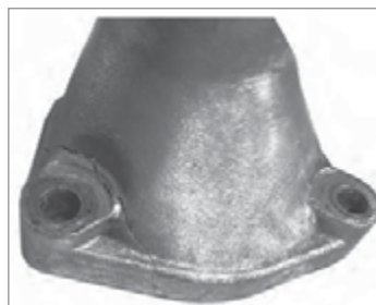
پ) نشستی از مجاری بیرونی (خرابی تجهیزات آب بندی)
