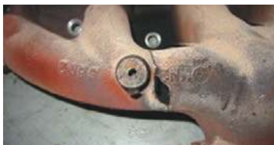
پ) شکستگی مانیفولد خروجی (چدنی)
