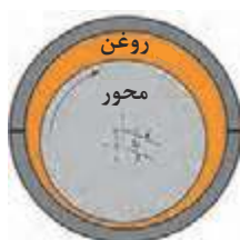
الف) لایه روغن بین یاتاقان و میل‌لنگ
