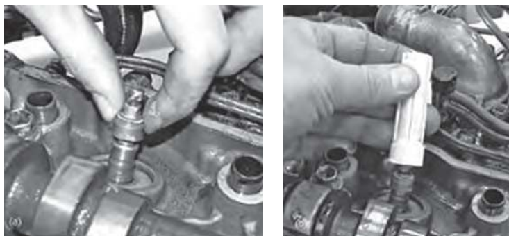
ب) روش جازدن کاسه نمد راهنمای سوپاپ
