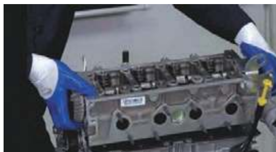
جدا کردن سر سیلندر از بلوکه
