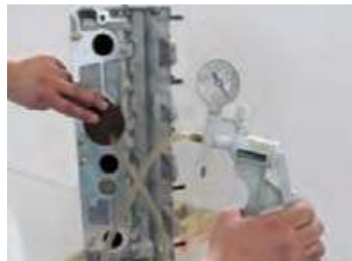
الف) نشتی سنجی سوپاپ‌ها با دستگاه خلا سنج ب) نشتی سنجی سوپاپ‌ها با مایع در راهگاه سوپاپ‌ها
