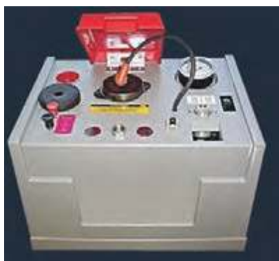
شکل ۲۸- دستگاه شمع پاک‌کن با توانایی آزمایش شمع
