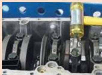
بازکردن کپه یاتاقان متحرک
