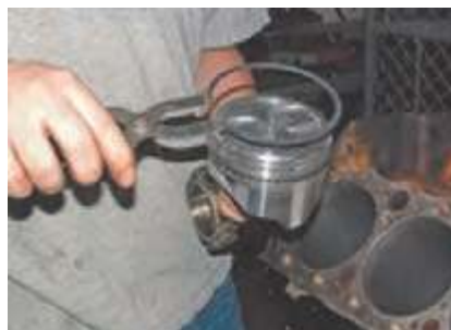
جا زدن رینگ روی پیستون با ابزار
