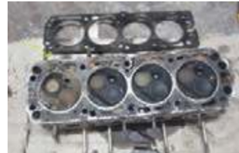
الف) سوختن واکس سرسیلندر و ورود مایع خنک کننده به سیلندر ۱
