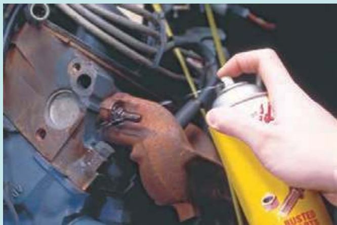
شکل ۴۷- استفاده از اسپری ضد قفل
