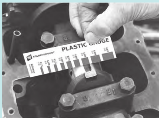
شکل ۹۸- بررسی قطر یاتاقان متحرک با پلاستی گیج
