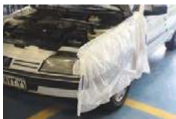
شکل ۶۷- آماده‌سازی خودرو برای باز کردن موتور
