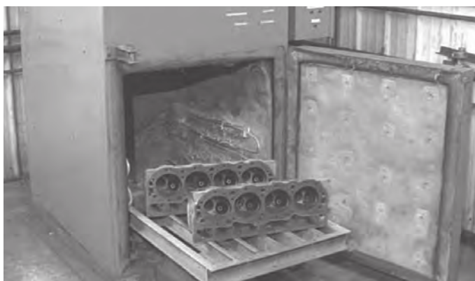
شکل ۶۳- دستگاه شست‌وشو و چربی‌زدایی اتوماتیک
