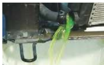
شیلنگ‌های سیستم‌های خنک‌کاری جدا شوند.
