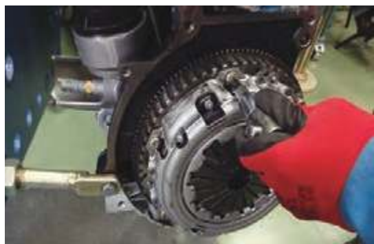
۲ مجموعه کلاچ از موتور جدا شود.
