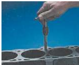
تمیز کردن و بررسی رزوه‌ها
