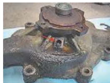
ت) شکستگی پایه‌ها
