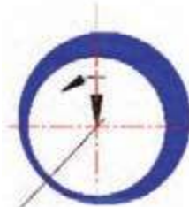
شکل ۴۲ - خلاصی بین یاتاقان و میل لنگ (فیلم روغن) در یک یاتاقان
