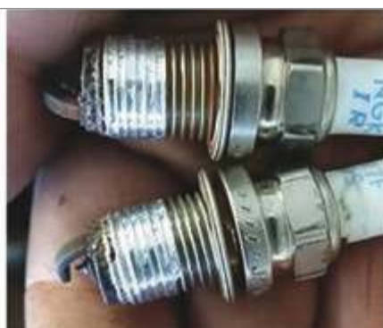
شکل ۷۲- بررسی رزوه های سرسیلندر
