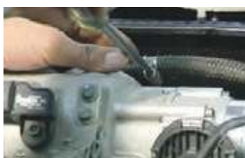
شیلنگ‌های سیستم سوخت‌رسانی جدا شوند.
