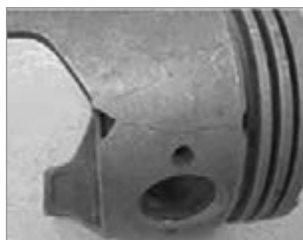
شکستگی دامنه پیستون
