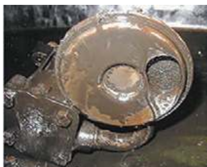
شکل ۳۶- صافی پمپ روغن جرم گرفته
