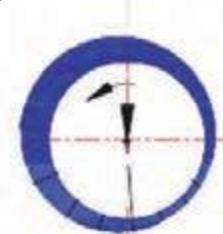
شکل ۴۲ - خلاصی بین یاتاقان و میل لنگ (فیلم روغن) در یک یاتاقان
