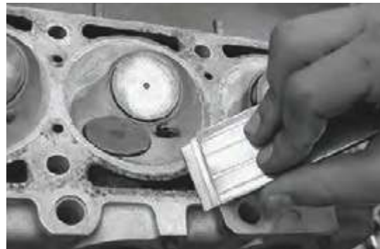
الف) رسوب‌زدایی کف سرسیلندر و اتاق احتراق
