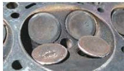
بررسی چشمی تاب سوپاپ
