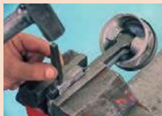
بازکردن کپه یاتاقان متحرک
