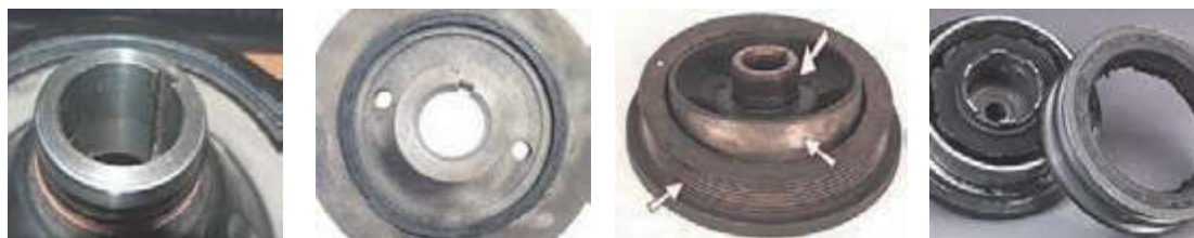
پ) ساییده شدن جای قرارگیری کاسه نمد
