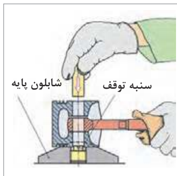
ب) گزن بین پرس در شاتون
