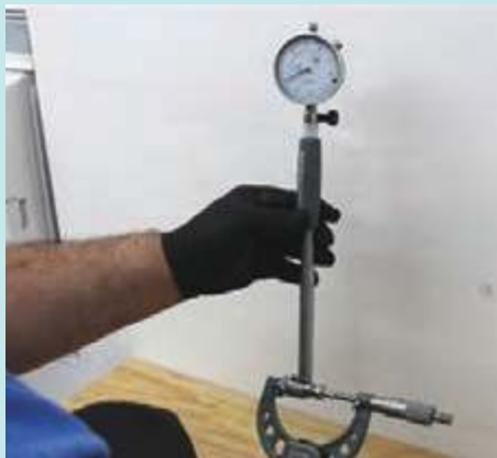
شکل ۸۹- روش تنظیم دهانه ساعت اندازه‌گیری
