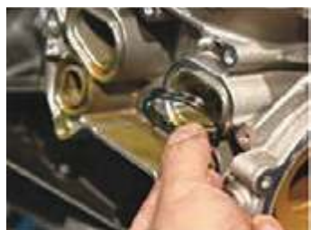
ج) بستن اورینگ ها و واشرهای خنک کن روغن
