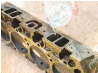
الف) نشتی سنجی سوپاپ‌ها با دستگاه خلا سنج ب) نشتی سنجی سوپاپ‌ها با مایع در راهگاه سوپاپ‌ها
