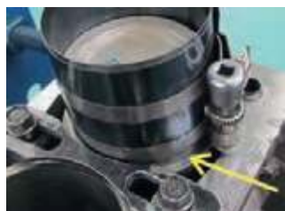
به کارگیری رینگ جمع کن
