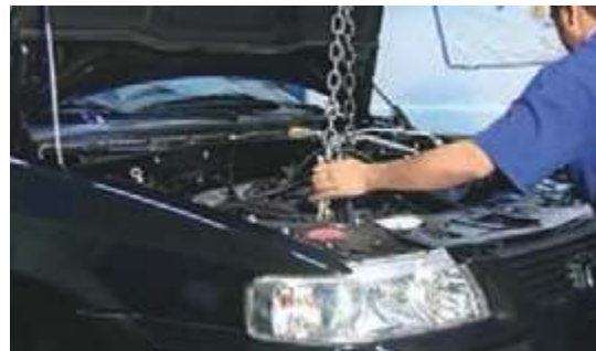
۱ موتور با بستن زنجیر جک موتور درآر در جای مناسب، مهار شود. ۲ دسته موتور باز شود و موتور بیرون آورده شود.
