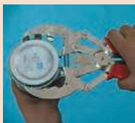
رینگ بازکن پیستون و بیرون آوردن رینگ
