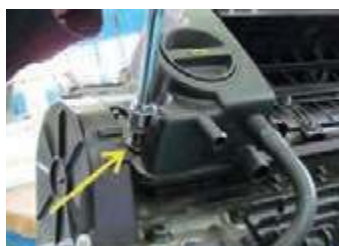
باز کردن در پوش سرسیلندر
