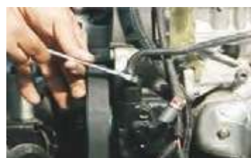
لوله‌ها و شیلنگ‌های فرمان هیدرولیک باز شوند.
