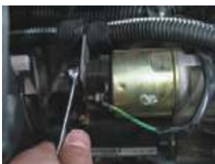
باز کردن اتصالات برقی استارت
