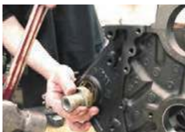
ب) ابزار مخصوص و روش جازدن پولکی
