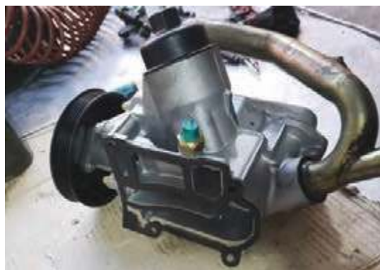
شکل ۳۱- بررسی واحد خنک‌کن روغن
