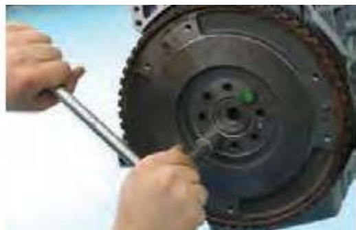
شکل ۷۹- باز کردن پیچ‌های فلایویل به ترتیب و بررسی آن
