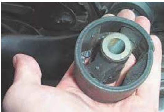
شکل ۵۹- پارگی دسته موتور
