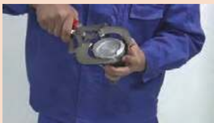
رینگ بازکن پیستون و بیرون آوردن رینگ
