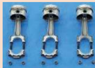
بازکردن کپه یاتاقان متحرک
