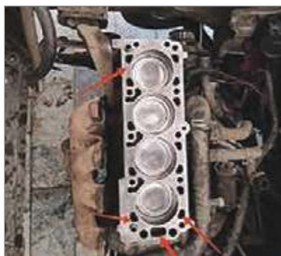
بررسی راهگاه‌های آب و روغن بلوکه موتور
