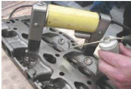
(الف) بررسی با دستگاه ترک یاب مغناطیسی
