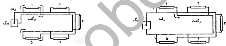
تصویر شماره ۲۸: لوله کشی با برگشت معکوس / تصویر شماره ۲۹: لوله کشی با برگشت مستقیم
